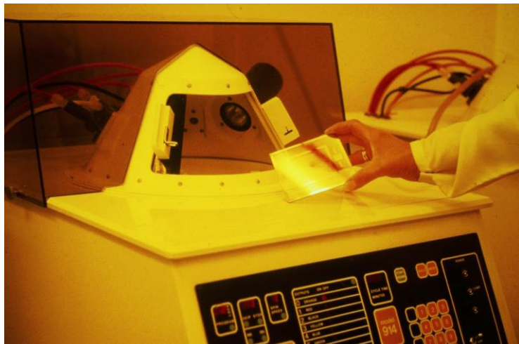
„Spin-Prozessor“ zur Entwicklung der Fotolack-Schicht und ähnlich auch zum Ätzen des Chroms für Vatermasken, 1977
