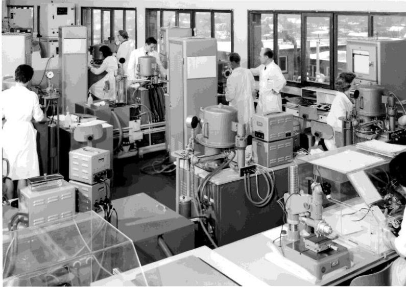
Bedampfungsanlage für Mesa Transistoren 3/1964, N-Geb
