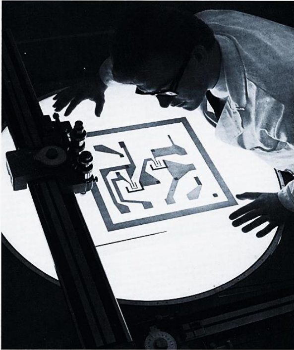
Die Vorlage für eine Maske wird in Maßstab 200:1 von einem Schneide-Plotter geschnitten, 1966
