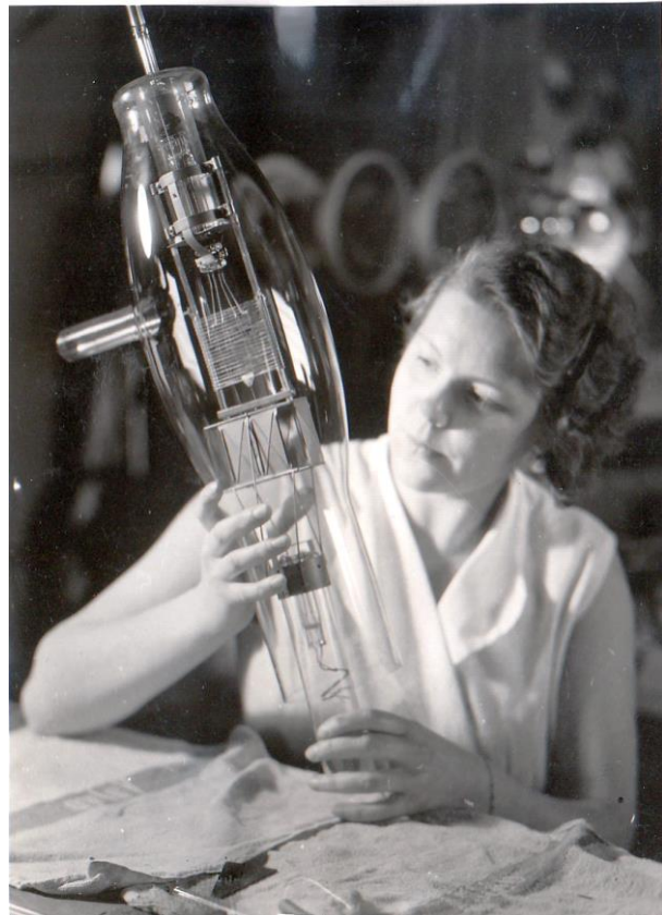
Einsetzen des Röhrensystems in eine Senderöhre, ca. 1925
