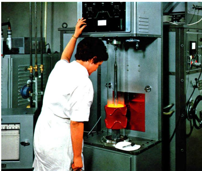
Apparatur zur Herstellung von Germanium-Einkristallen nach dem Tiegel-Ziehverfahren, 1964
