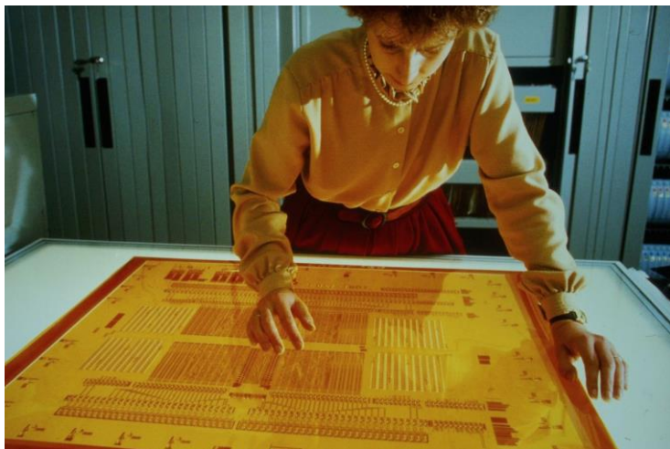
Optische Kontrolle an einer rück-vergrößerten Vatermaske, 1986.
