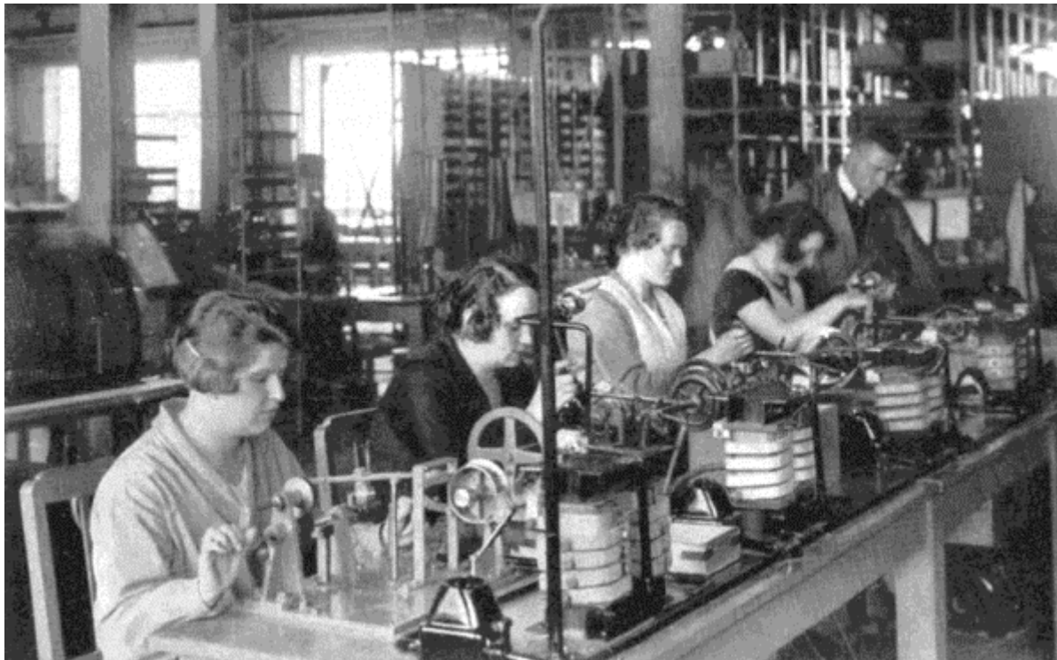
Die Gitter der Röhren wurden mit der Hand als Drahtwendeln gewickelt (1927)
