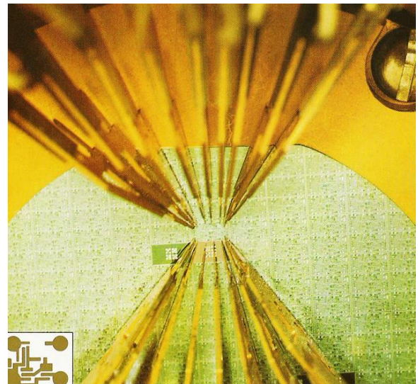
Testen auf dem Wafer. Durch feine Spitzen wurden die Kontaktflächen (Pads) kontaktiert, 1974
