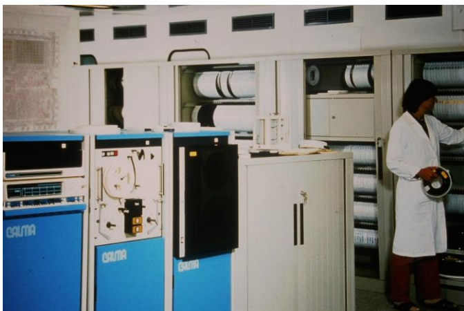
Die Layout-Daten wurden auf Magnetbändern gespeichert, 1976
