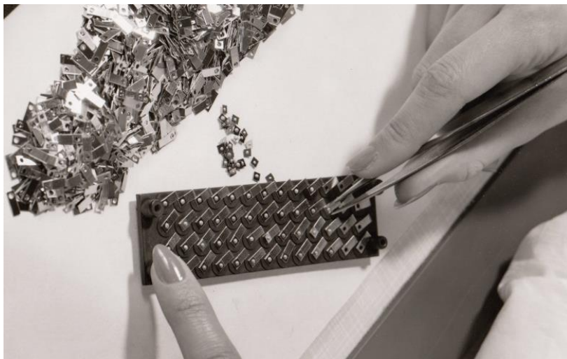
Montage des legierten Germanium-Plättchen auf Lötbleche, die als Basisanschluss und Halterung im Gehäuse dienen, 1959
