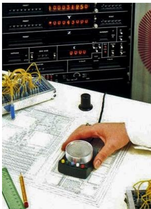
Eine integrierte Schaltung wird in 200facher Vergrößerung gezeichnet. Die Kolorierung dient der Übersicht über die einzelnen Diffusionsvorgänge und der Kontrolle des Gesamtentwurfs.
