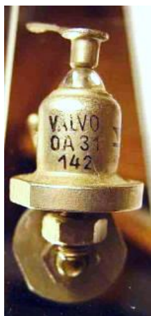
3 A Leistungsdiode OA31 von 1957 aus Hamburg
