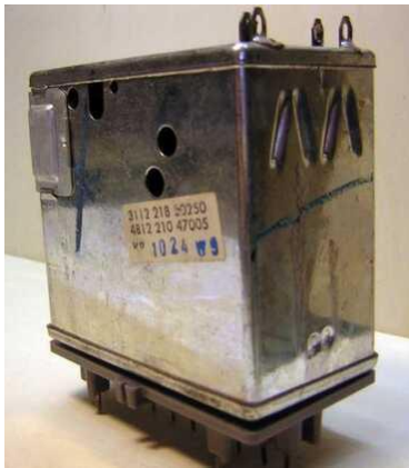
Erster mit Kapazitäts-Dioden abgestimmter VHF/UHF Tuner von Philips (KD2 gebaut in der Fernseh-Fabrik in Krefeld), 1968
