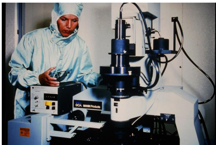
Pattern-Generator zum optischen Schreiben von Vatermasken. Damit wurde der Fotolack auf Glaträgern belichtet, 1977
