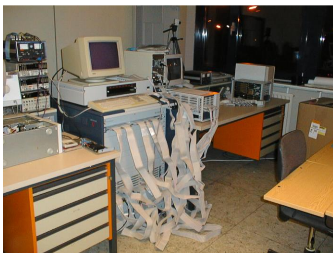
FPGA Maschine „Quickturn“ zur Verifikation von großen digitalen Schaltungen, 1997
