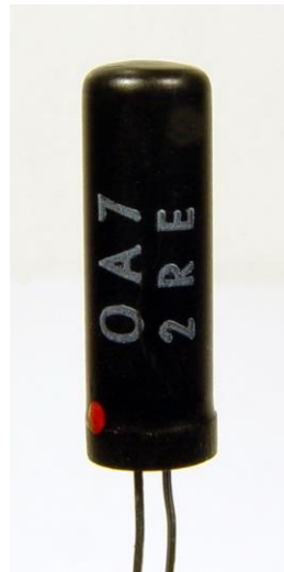
Aufbau der Valvo Germanium Golddraht-Diode OA7 (ca. 1956 aus Nijmegen)
