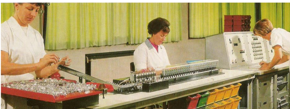
Halbautomatisches Endmessen und Selektieren von Transistoren 1969 [Valvo 1969 „Etwas für Sie“ Link 017]
