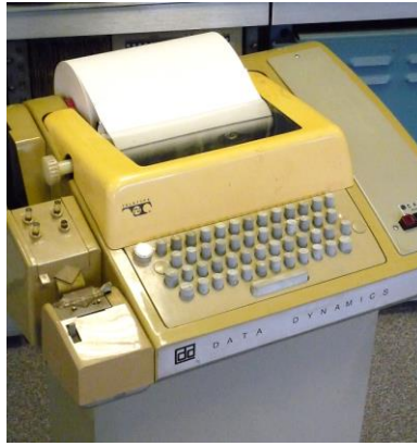
Teletype zum Programmieren, Lochstreifen stanzen und einlesen, 1973
