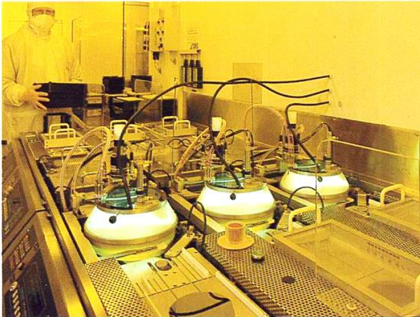
Die Beschichtungsanlage für Fotolack im Gelbraum lief weitgehend automatisch, 1994
