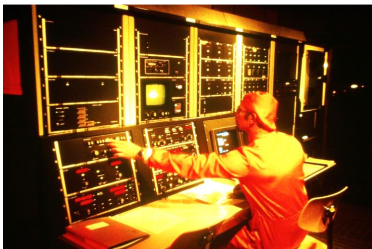
Elektronenstrahl-Anlage (E-Beam, Philips EBPG) zur Belichtung von Vatermasken, 1979
