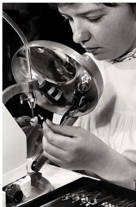
Montage eines Kleinsignal-Legierungs-Transistors, 1959
