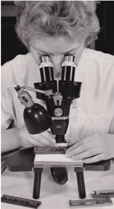
Graphitlehre zum Legieren von Emitter und Kollektor [Link: 1972 Betriebliche Warenkunde 1 - Halbleiter]
